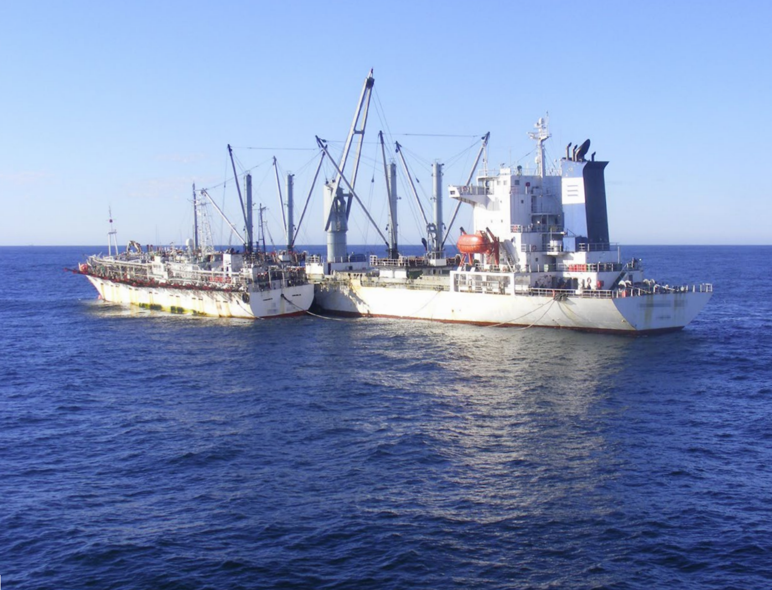
Transbordement en mer entre un lamparo à turlutte et un navire frigorifique dans l'ASO. (Crédit : Garde-côtes argentins).
