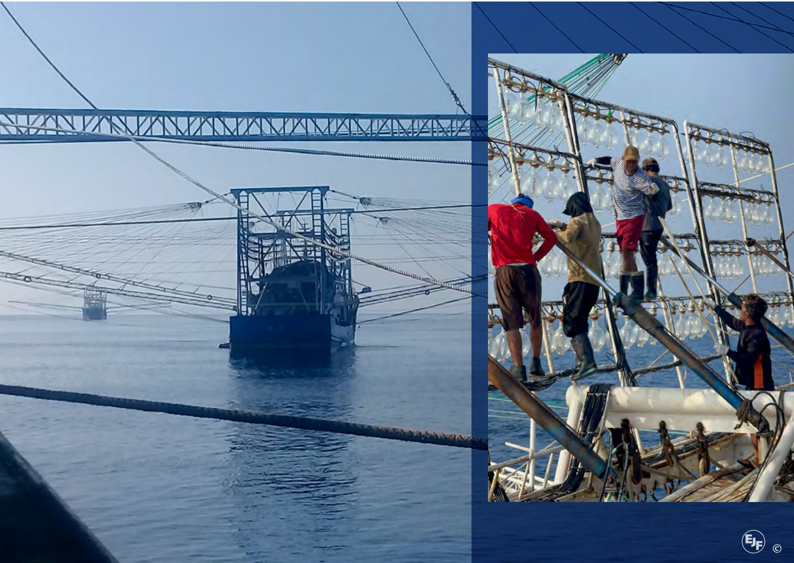
북서 인도양(NWIO)의 한 중국 국적의 집어등 선망선에서 촬영된 것으로 알려진 사진들. (좌) 멀리 다른 두 척의 집어등 선망선이 보인다. 선박 상부 구조물과 함께 그물을 끄는 붐, 그리고 고출력 조명 장비를 장착한 부분이 모두 확인된다. (우) 선원들이 집어등 선망선에서 조망 장비 관리 작업을 하고 있다.
