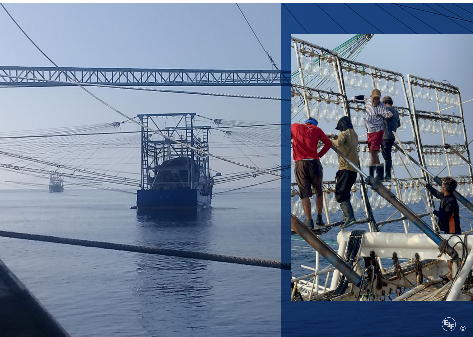
Fotografías tomadas a bordo de buques chinos de cerco con luz en el océano Índico noroccidental. (Izquierda) Dos buques de cerco con luz a lo lejos. Son visibles los tangones que soportan la red, junto con la superestructura del buque, que alberga los equipos de iluminación de alta potencia. (Derecha) Pescadores realizan tareas de mantenimiento en las luces de un buque de cerco con luz.
