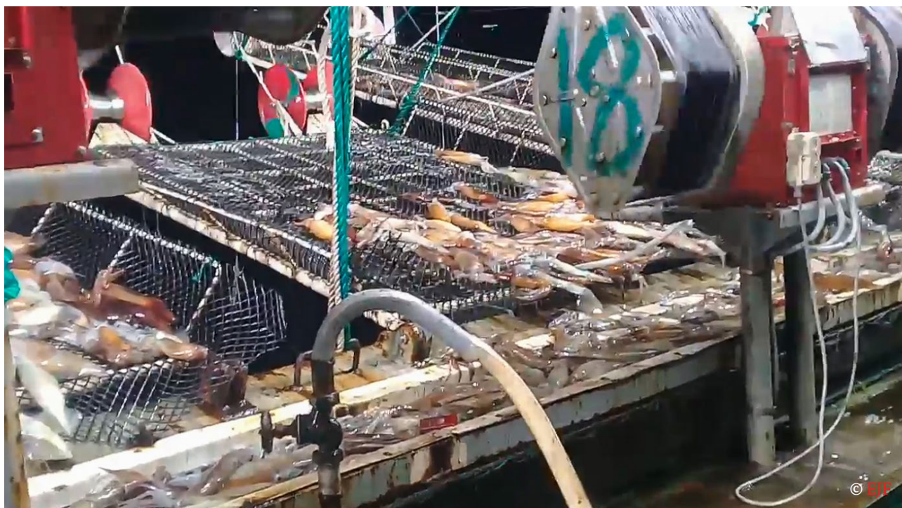
Imagen que muestra cómo se suben a bordo los calamares tras ser capturados por máquinas poteras automáticas – buque con bandera china operando en el Atlántico Sudoccidental.
